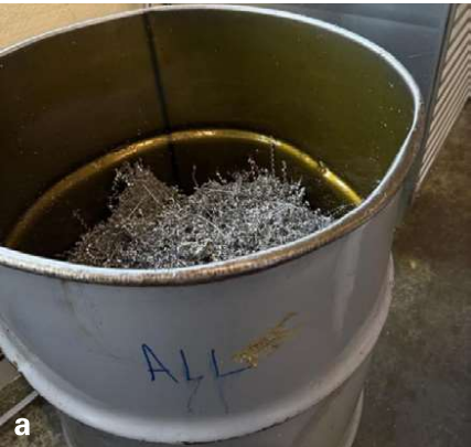
Figura 2 Lavorazione dell'alluminio con macchina utensile, per (a) fresatura (cortesia Gemma Global); (b) polvere da lavorazione al tornio (cortesia TEDESCHI Sas)
