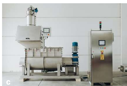
Figura 6 Gestione della polvere di alluminio: (a) sacchi per il trasporto, (b) impianto di aspirazione ed abbattimento delle polveri smaltimento; (c) Inertizzatore; (d) camion per il trasporto finale dei fanghi (cortesia MAR. ECO S.r.l.)
